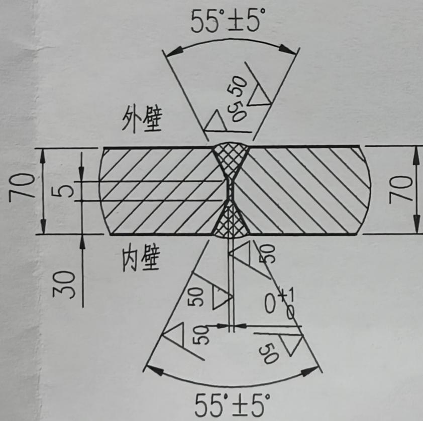
筒体与管板焊缝焊接详图
