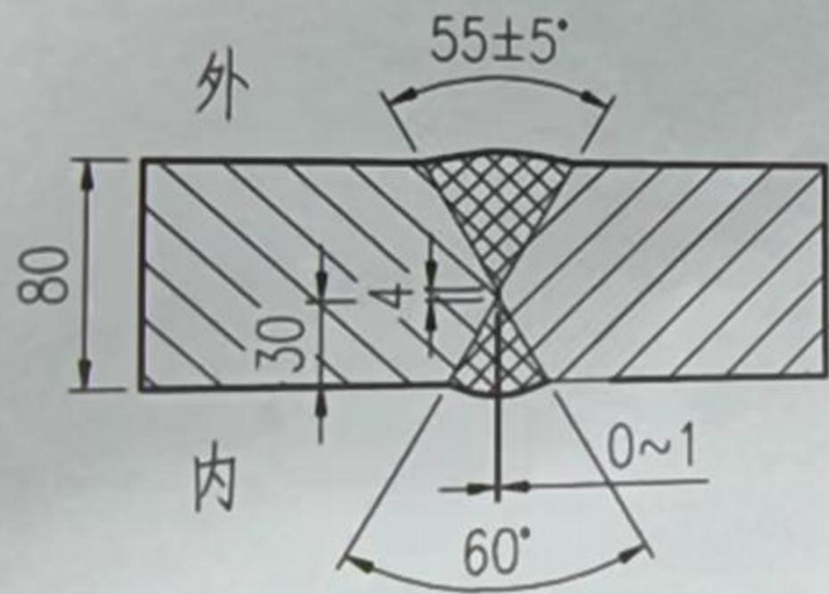
纵焊缝焊接详图
