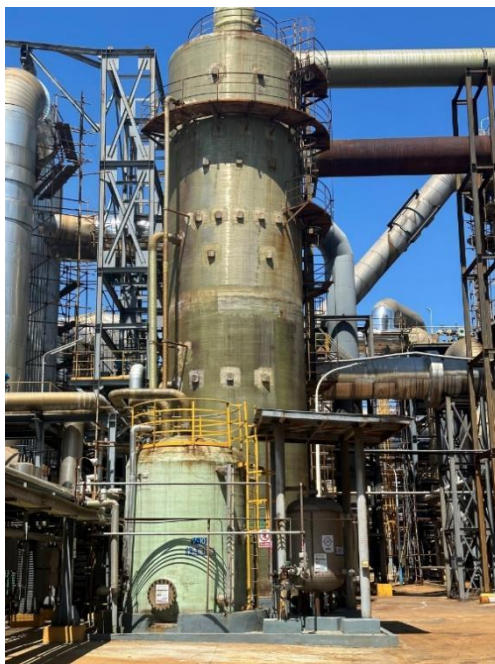
图 6.1.1-3 索普新材料公司 60 万吨硫酸装置尾气吸收塔图
