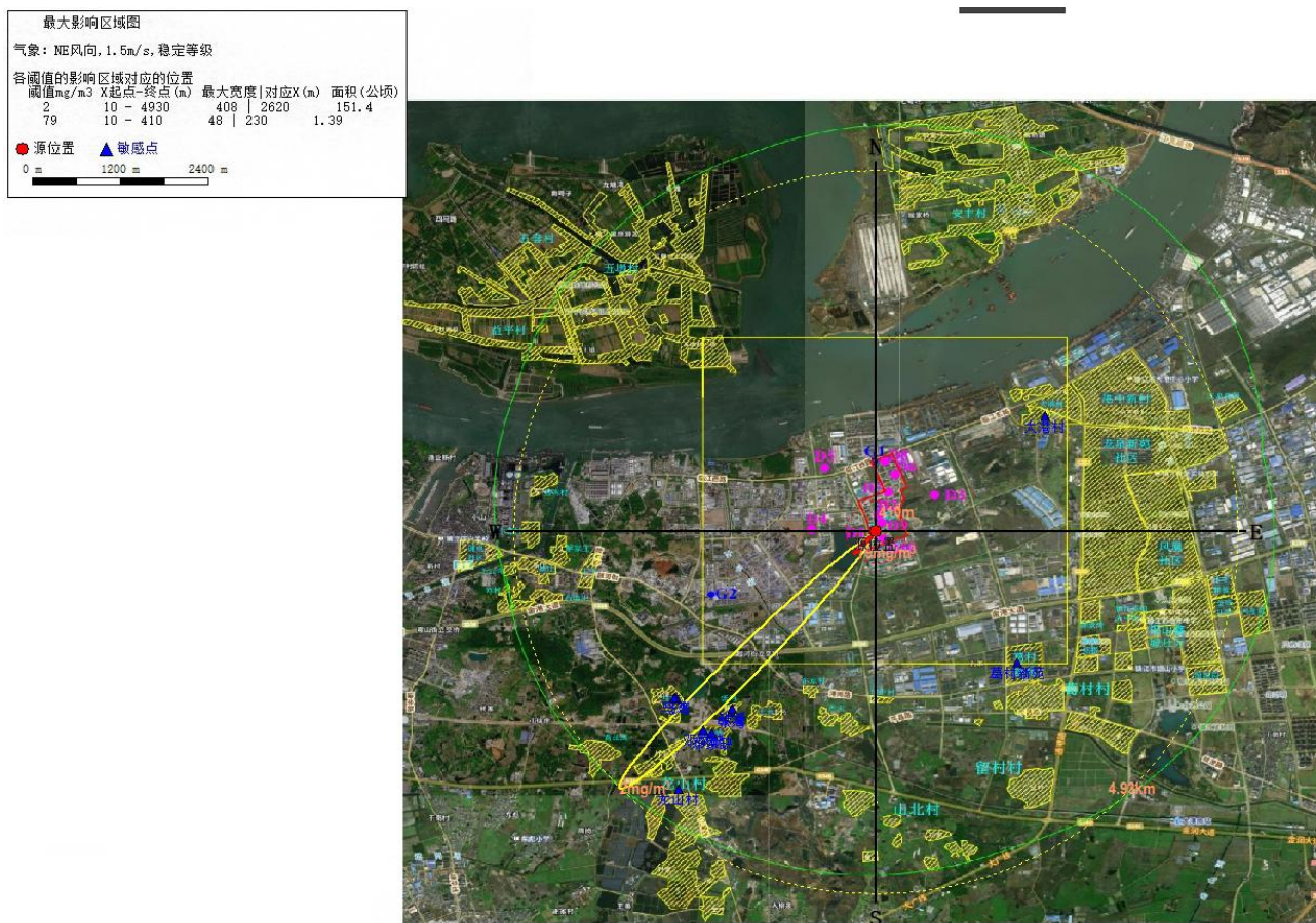
图 5.2.7-1 最不利气象条件下 SO 2 扩散瞬时浓度随距离的变化特征 (mg/m 3 )
